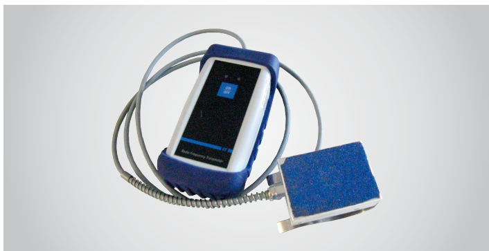
Sensore di sforzo al pedale trasmissione via radio
